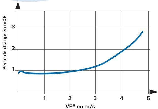
\* VE = Vitesse Equivalente = Vitesse moyenne dans la section d'entrée.
