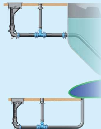
Poteaux d'aspiration pour réseaux secs - P.A.type S.
