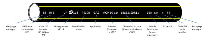
Contrairement à un tube uniquement conforme à la norme NF EN 1555, un tube certifié à la Marque NF114 Groupe 1 est fabriqué avec une matière 100% vierge de façon certaine et possède un marquage gravé à chaud sur le tube avec notamment les codes de traçabilité internationaux ISO du fabricant et de la matière première. L'interprétation de ces codes est disponible sur le site : <a href="https://www.traccoding.com">www.traccoding.com</a>
