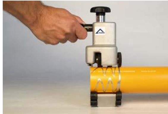
Tourner la poignée de serrage (2) dans le sens des aiguilles d'une montre de sorte que les galets (5) et (6) soient en contact avec le tube.
