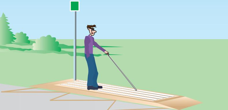
**La bande de guidage Band'Guide®** est un dispositif d'interception et de guidage tactile au sol à l'usage des personnes aveugles et malvoyantes ou des personnes ayant des difficultés d'orientation.
