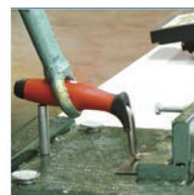
Test de flexion axiale du manche
