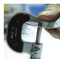
Mesure de l'épaisseur de la lame
