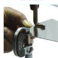
2 points de mesure à l'aide d'un micromètre
