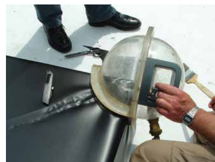
Test d'étanchéité au niveau des angles
