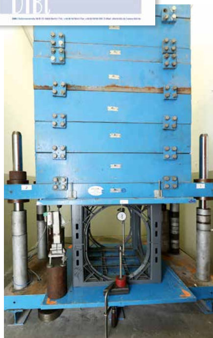
Essai de longue durée avec charges extrêmes verticales
