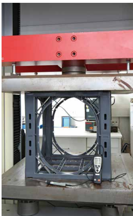
Essai à court terme avec charge verticale
