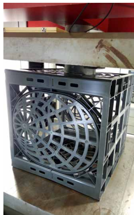
Charge de compression par estampage de la plaque latérale
