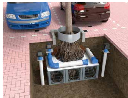
La combinaison du système d'irrigation d'arbres, de l'aérateur de racines, de l'anneau d'irrigation et du D-Raintank 3000® assure une implantation optimale de l'arbre sans compactage du substrat au niveau des racines.
