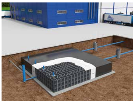
Système de stockage ou de rétention avec D-Raintank 3000® et enveloppement ultérieur par géomembrane avec regards nettoyables en amont et regards limiteurs de débit en aval pour le stockage permanent des eaux pluviales.
