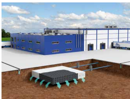
Bassin d'infiltration pour le drainage des toitures et des parkings, combinée au caniveau d'infiltration D-Rainclean® pour le traitement des eaux pluviales polluées.
