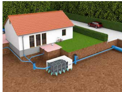
Système d'infiltration avec D-Raintank 3000® installé en troncçon, avec regard nettoyable en amont et regard limiteur de débit en aval. Les raccords sont constitués par des tuyaux HSK pour les eaux pluviales.
