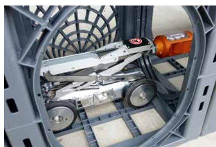
> Inspection par caméra sans rail d'inspection
