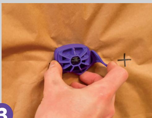
Positionner la tête sur la flèche et la verrouiller par actionnement du levier.
