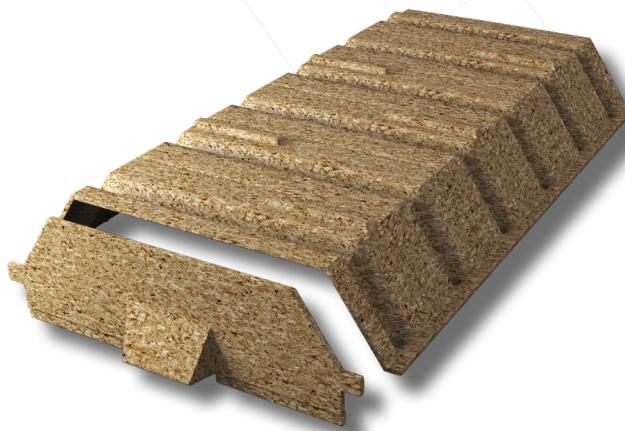
L'entrevois coffrant Optibois est fabriqué à partir de copeaux de bois recyclés pressés pour la réalisation de tous types de bâtiments, tant dans le neuf qu'en rénovation. Il est associé à des tympans qui garantissent l'étanchéité lors du coulage de la table de compression.
