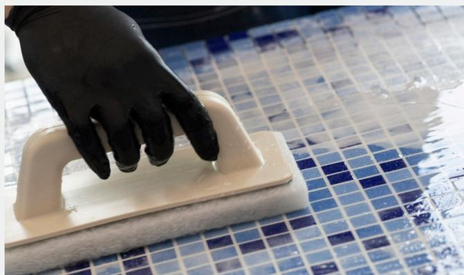
Frottoir conçu pour le nettoyage et la finition des joints. Il est composé de deux feutres, un feutre noir hautement abrasif ( finition des joints ), et un feutre blanc peu abrasif ( nettoyage des joints ). La fixation des feutres s'effectue par un système Velcro. L'épaisseur des feutres est de 20<sup>mm</sup>.
