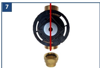
Au montage du support tabernacle, aligner la diagonale du carré de manœuvre sur l'axe de la sortie du robinet de manière à accoupler l'axe sur la sphère. Le maintenir dans cette orientation jusqu'au vissage complet du support tabernacle
