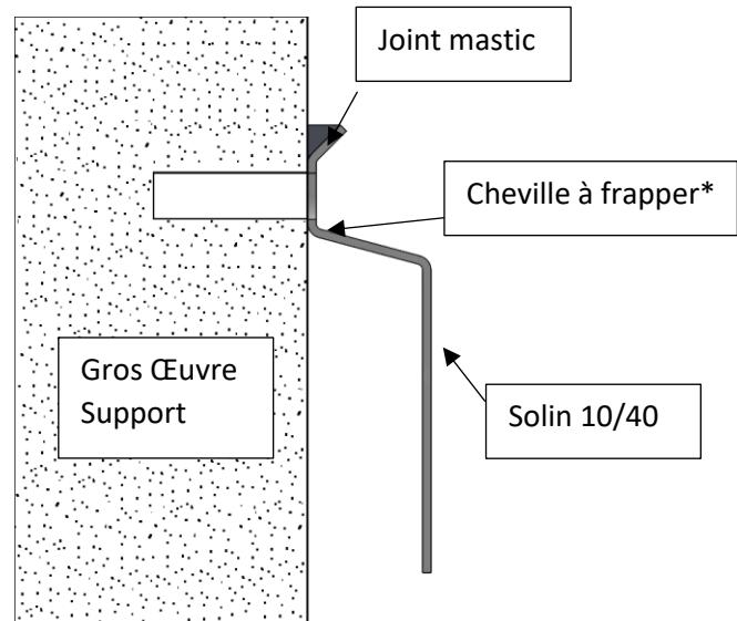
Le RK-SOLIN-ALU 10/40 est un système de solins qui assure la protection des relevés d'étanchéité en toitures
