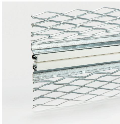
**Le joint de dilatation déployé est intégré à l'enduit de façade, il assure l'étanchéité des éléments de la maçonnerie et absorbe les différents mouvements du bâtiment.**
