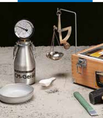
Mesure de l'humidité de la chape Mapecem avec hygromètre à carbure
