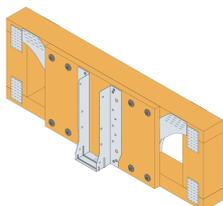
Fixation par les brides latérales sur une poutre métallique ajourée avec renfort bois
