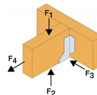
Fixation par les brides supérieures sur un support poutre en I avec renfort
