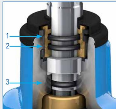
**08** : Triple étanchéité sur la tige de commande pour assurer l'étanchéité avec le test de la durée de vie du produit. (2500 cycles).
