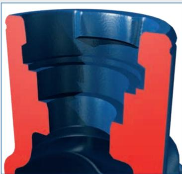
**01** : Dû au design du système à baïonnette breveté, le robinet-vanne INFINITY n'a pas de filetage, permettant un **revêtement continu** et évitant ainsi les problèmes de corrosion.
