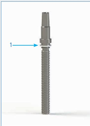
**04** : Vis de manœuvre en une seule pièce. Pour une **meilleure résistance aux efforts axiaux et pour résister à des couples de fonctionnement plus élevés**. Une rondelle en polyamide (1) placée sous le collier permet de réduire le couple de frottement et de protéger le revêtement à l'intérieur du chapeau.
