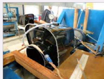
Validation de la tenue à la pression d'un clapet MULTI 315. Le même type de test est appliqué à tous les clapets de la gamme MULTITUBE.
