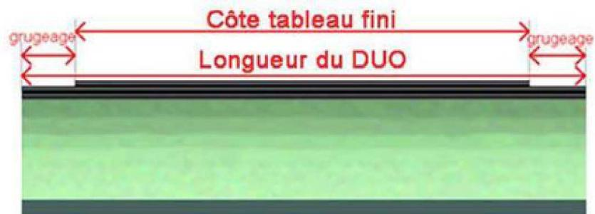
Figure 2.14 : Préparation du DUO pour l'enduit
