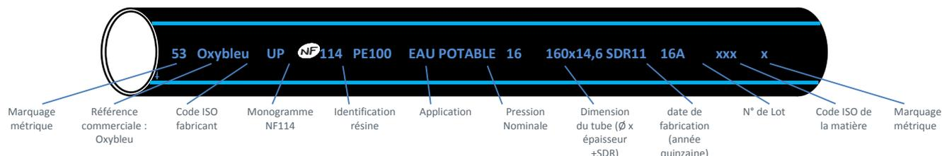
Contrairement à un tube uniquement conforme à la norme NF EN 12 201, un tube certifié à la Marque NF114 Groupe 2 est fabriqué avec une matière 100% vierge de façon certaine et possède un marquage gravé à chaud sur le tube avec notamment les codes de traçabilité internationaux ISO du fabricant et de la matière première. L'interprétation de ces codes est disponible sur le site : [www.traccoding.com](http://www.traccoding.com)
