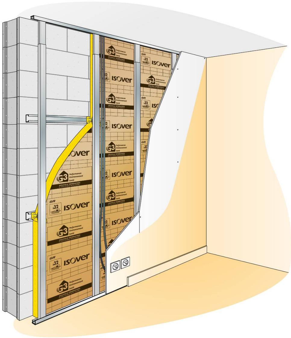
Figure 12 : Pose du parement final
