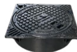
Cadre et tampon fonte B125 ou C250 EN124 certifiés NF
