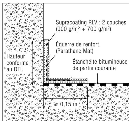
Dans certains cas (voir ATEX), l'utilisation de Supracoating RLV permet de s'affranchir des dispositifs écartant les eaux de ruissellement.
