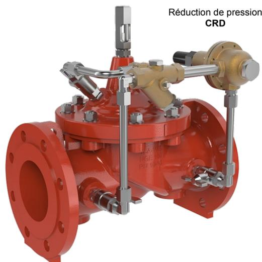
La SERIE CLA-VAL 90 réduit la pression amont variable en une pression aval inférieure et constante sans égard aux fluctuations de débit et/ou de pression amont.
