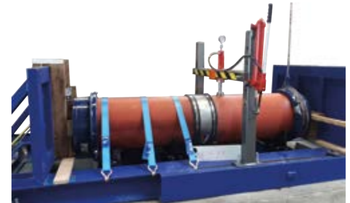
Essais de résistance au cisaillement d'un raccord FLEX-SEAL Plus® SC445. Le même type de test est appliqué à tous les raccords de la gamme FLEX-SEAL Plus®.
