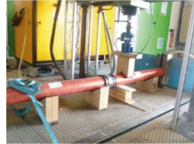
Tests réalisés sur raccord FLEX-SEAL Plus® SC dans le cadre de nos certifications. Rapport d'Essais disponible sur demande.
