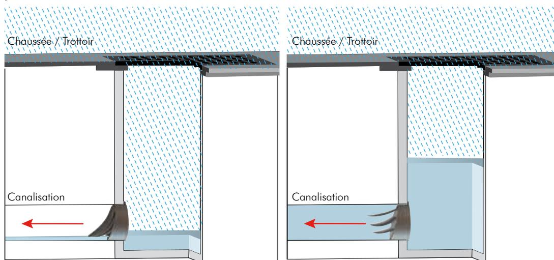
1. Un très faible flux permet l'évacuation à travers le clapet anti-odeur.
