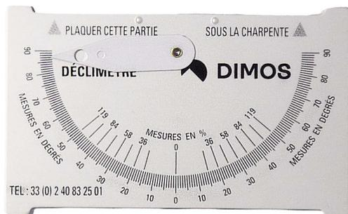
Les déclimètres permettent de déterminer avec précision la pente avant le traçage du pureau.
