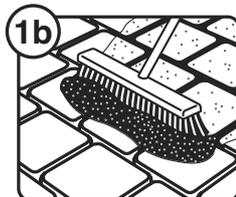
Étaler le Sable pour joints uniformément sur la surface qui doit être parfaitement sèche. Remplir entièrement les joints sur toute la profondeur des dalles ou des pavés. Il est proscrit de remplir partiellement les joints avec du sable classique.
