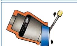
2. Extraire la bague d'ancrage avec un tournevis. Ne pas ré-utiliser cette bague.
