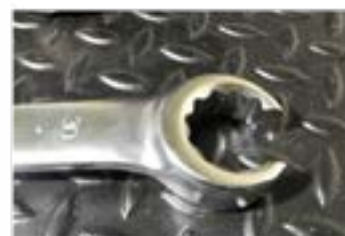
Clef à tuyauter 30 : maintenance des flexibles
