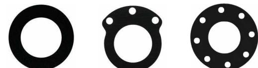
**Conditions de montage :** Brides fonte / acier / inox, hors collet bride selon norme EN 1092-1 ; Portées propres et parallèles, graissage des boulons avant assemblage ; Deux serrages en croix à la clef dynamométrique, avec un intervalle optimal de 30 minutes.
