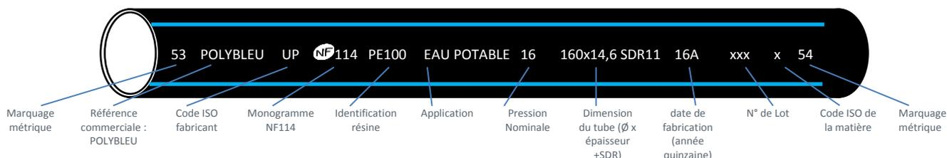
Contrairement à un tube uniquement conforme à la norme NF EN 12 201, un tube certifié à la Marque NF114 est fabriqué avec une matière 100% vierge de façon certaine et possède un marquage gravé à chaud sur le tube avec notamment les codes de traçabilité internationaux ISO du fabricant et de la matière première. L'interprétation de ces codes est disponible sur le site : [www.traccoding.com](http://www.traccoding.com)
