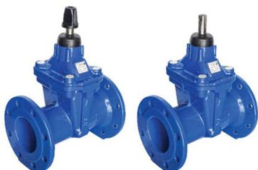
Les robinets-vannes EURO 20 NEW sont des appareils de sectionnement à opercule surmoulé d'élastomère pour des diamètres DN40 à 400 et connexion au réseau à brides destinés à être utilisés en position tout ou rien jusqu'à PFA 16 bar.
