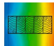
faibles épaisseurs des âmes (8 et 6 mm) font des poutres STEICOjoist et STEICOwall des éléments de structure à faible déperdition thermique. Comparé à des ossatures en bois massif on réduit en moyenne de 50% les déperditions, obtenant ainsi une paroi plus performante. Les poutres pré-isolées, exclusivité STEICO, facilitent l'usage de panneaux de laine isolante semi-rigides.
