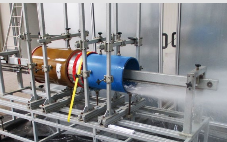
Test de rinçage haute pression selon la norme DIN 19523 dans les locaux de la société iro GmbH, à Oldenburg
