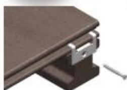
Les lames en bordure peuvent être fixées par un clip de début et de fin. Ce clip se visse dans la lambourde par le côté ou le dessus (e.g. début de terrasse contre un mur). Il permet de maintenir les lames en périphérie sans vis apparente
