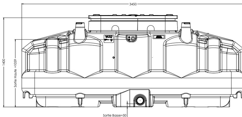
Filtre compact composé de 2 cuves en PEHD (Polyéthylène à Haute Densité) : 1 fosse toutes eaux (munie du préfiltre PF17 et du connecteur sécurisé CPS) et 1 filtre naturel végétal composé de fragments de coco pour filtration des eaux usées domestiques
