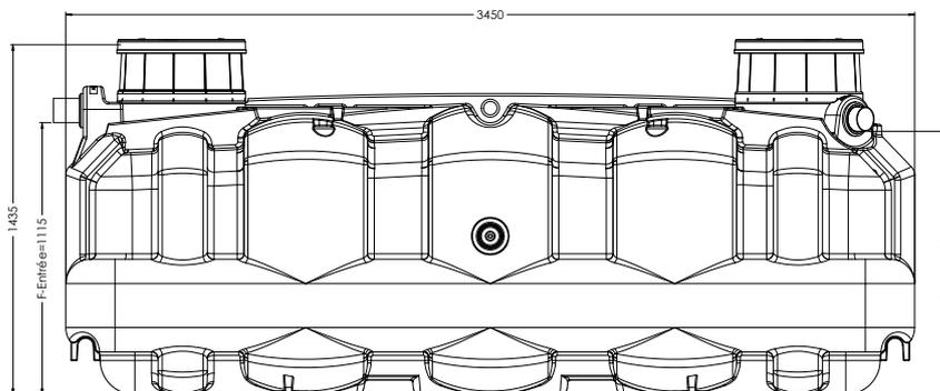
Filtre compact composé de 2 cuves en PEHD (Polyéthylène à Haute Densité) : 1 fosse toutes eaux (munie du préfiltre PF17 et du connecteur sécurisé CPS) et 1 filtre naturel végétal composé de fragments de coco pour filtration des eaux usées domestiques
