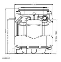
Filtre compact composé de 2 cuves en PEHD (Polyéthylène à Haute Densité) : 1 fosse toutes eaux (munie du préfiltre PF17 et du connecteur sécurisé CPS) et 1 filtre naturel végétal composé de fragments de coco pour filtration des eaux usées domestiques
