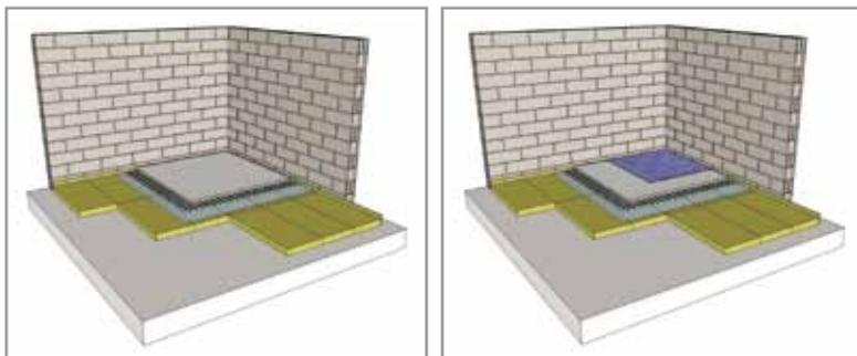
Si des canalisations sont prévues, elles doivent être placées dans le ravoirage supplémentaire. L'épaisseur du ravoirage doit être telle que la génératrice supérieure de la canalisation du plus grand diamètre incorporé tangente le nu du ravoirage. Les canalisations, fourreaux ou conduits ne doivent pas se croiser.
