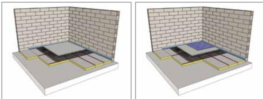
Seules les cloisons de distribution légères (< 150 kg/m linéaire) peuvent être montées après exécution de la chape flottante lorsqu'il n'y a pas d'exigence d'isolation acoustique entre les locaux séparés par cette cloison. Tout autre type de parois verticales doit poser sur le gros œuvre.
