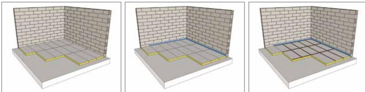
Les panneaux doivent être posés contre le bandeau afin d'en assurer la tenue et d'obtenir une surface d'isolant continue.
