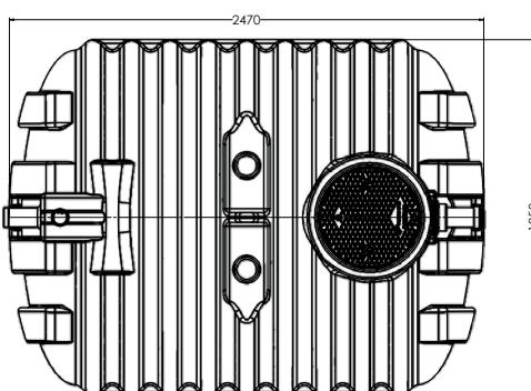
Fosse toutes eaux en PEHD (Polyéthylène à Haute Densité) en amont d'une filtration traditionnelle (fosse munie du préfiltre PF17 et du connecteur sécurisé CPS)
