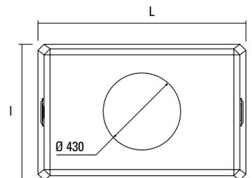
Le bac dégraisseur est destiné à la rétention par flottation des matières lipidiques, graisses et huiles contenues dans les eaux ménagères.
