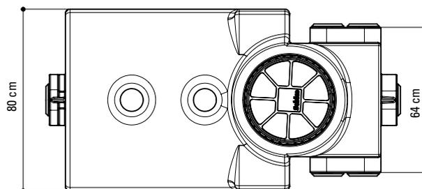
L'épandage a pour fonction de recevoir les eaux prétraitées issues de la fosse septique ou du décanteur digesteur et de permettre leur répartition, leur infiltration et leur épuration dans le sol. L'installation de la chasse automatique en tête d'épandage améliore l'efficacité et augmente sa longévité.
