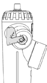
Clapet d'entrée d'air «Airclap»
